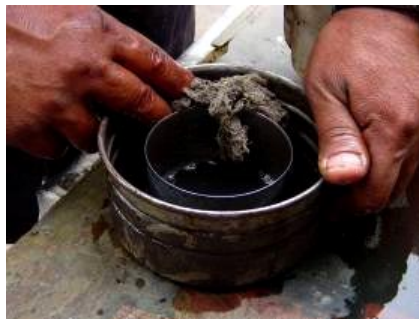
Fig. 2.4. Limpieza del tazón del filtro en baño de aceite o húmedo. La limpieza se realiza con paño y petróleo (foto Fredy Cáceres)
