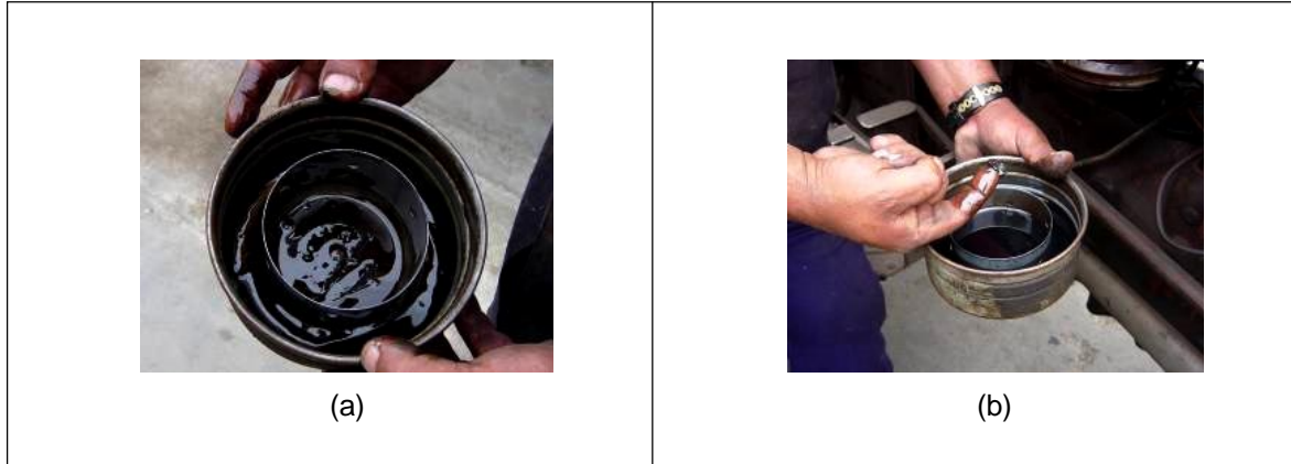
Fig. 2.3 Taza de aceite de un filtro húmedo: (a) Lodo acumulado en el tazón; (b) Consistencia del lodo acumulado (Foto Fredy Cáceres)
