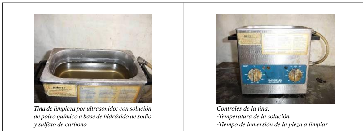
Fig. 3.5 Tina de limpieza por ultrasonido (foto F. Cáceres)
