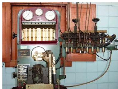
Fig. 3.6 Banco de pruebas de bomba de inyección (foto F. Cáceres)
