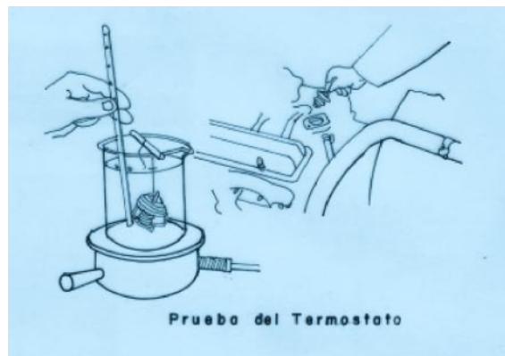
Fig. 5.3 Esquema de la prueba del termostato (F. Cáceres)
