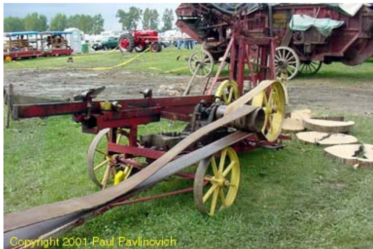
Fig. 8.1 Uso de Polea y faja plana
