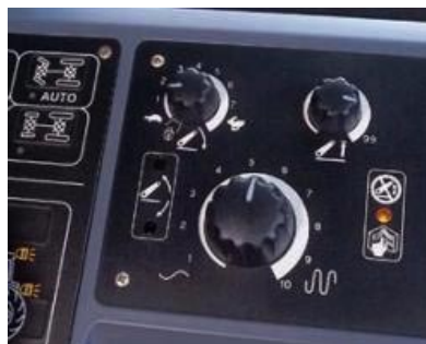
Fig. 7.3 Panel moderno de control del sistema hidráulico (landini)
