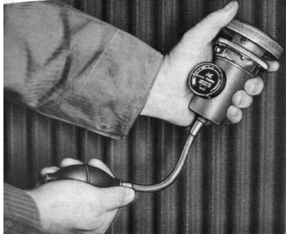
Fig. 5.4 Medida de la presión de la tapa del radiador( Jhon deere).
