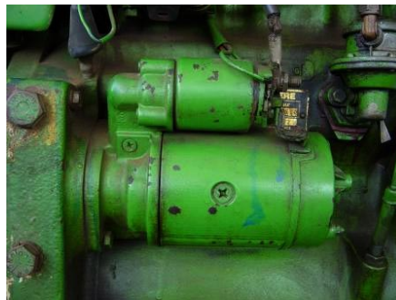
Fig. 6.9 Motor de arranque montado en el tractor (foto F. Cáceres)
