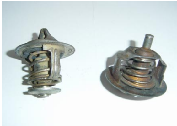
Fig. 5.2 Termostatos en buenas condiciones (Foto F. Cáceres)
