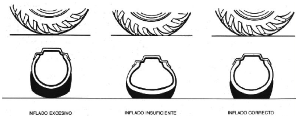
Fig.11.3 Inflado excesivo, causa desgaste rápido al centro de la banda de rodadura y quita flexibilidad a los neumáticos. Inflado insuficiente, Causa excesiva flexión de las paredes laterales originando sobrecalentamiento. Ambos dañan a los neumáticos.
