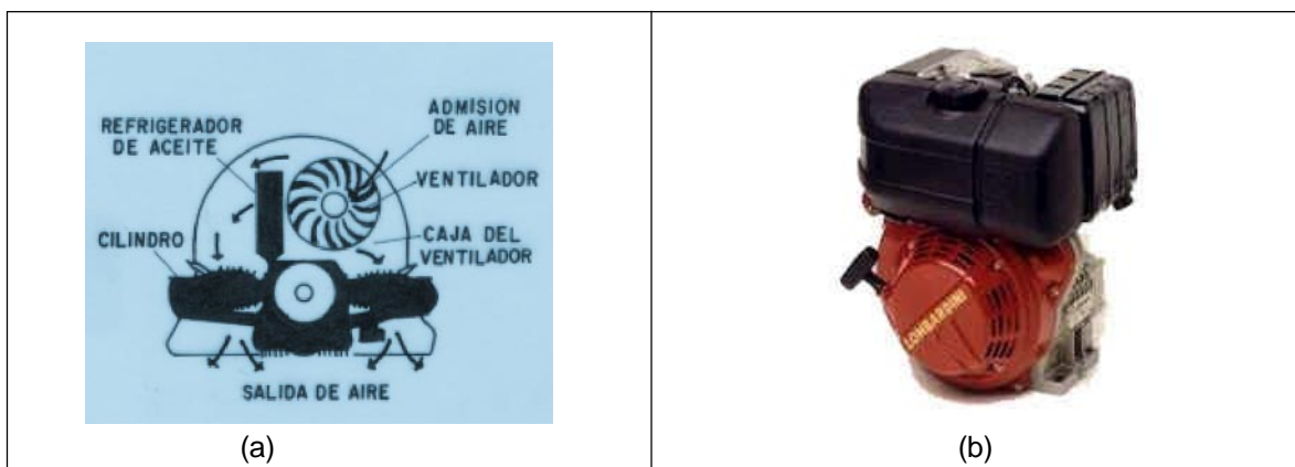
Fig. 5.6 Enfriamiento por aire, (a) esquema del sistema, (b) motor estacionario (F. Cáceres)
