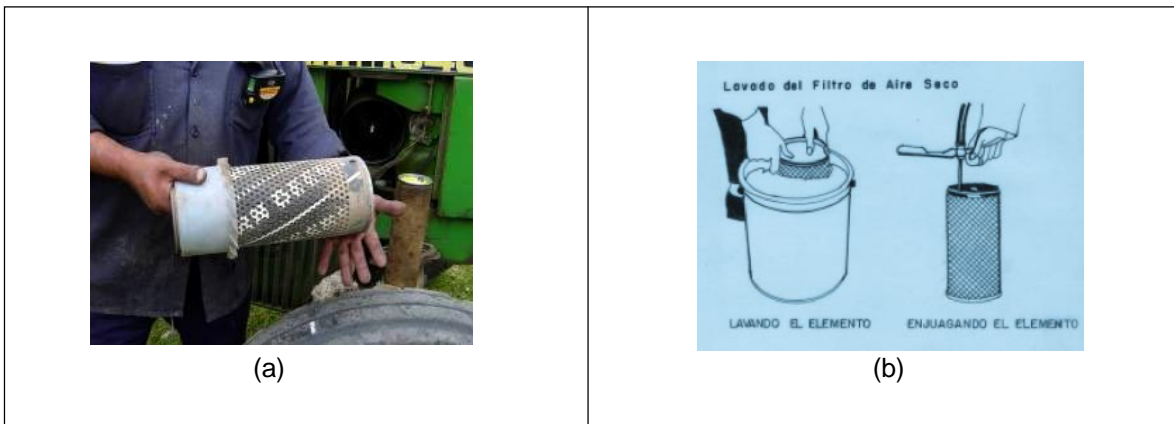
Fig. 2.7 Limpieza del elemento primario del filtro de aire. (a) retiro del polvo golpeando en la palma de la mano; (b) Lavado y soplado del elemento filtrante primario.
