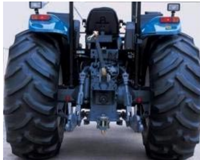
Fig. 7.2 Enganche en tres puntos (Ford)
