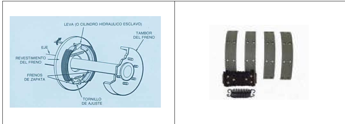
Fig. 10.6 Frenos de zapata, montado y solo zapatas (Jhon Deere)
