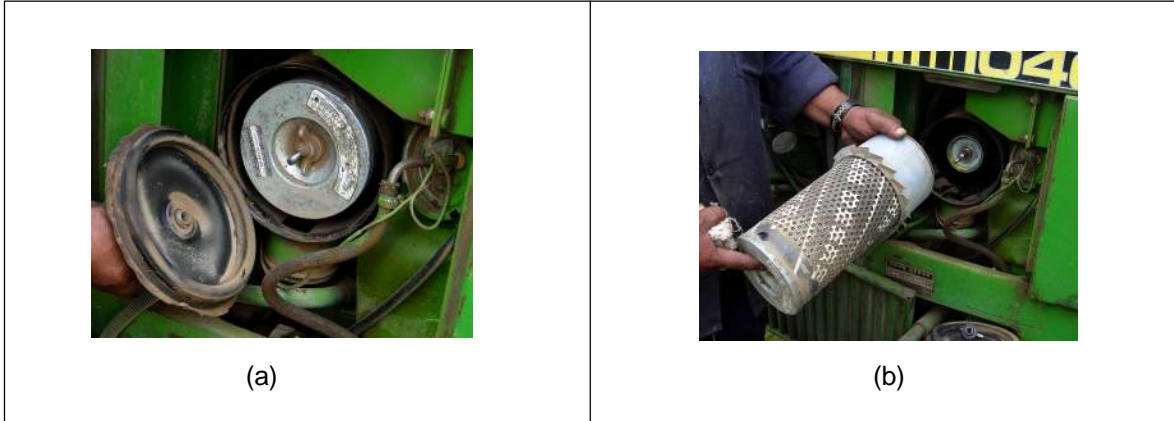
Fig. 2.6. Desmontaje del filtro seco; (a) Filtro primario y taza de polvo; (b) Filtro primario con aletas y vista del filtro secundario (foto F. Cáceres)
