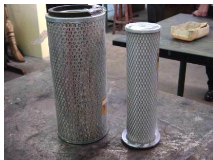
Fig. 2.1 Elementos filtrantes del filtro de aire, primario y secundario Respectivamente (foto por Fredy Cáceres)
