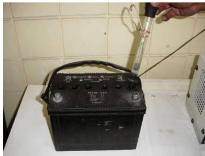
Fig. 6.2 Medida de la carga de la batería con el hidrómetro de bulbo (foto F. Cáceres)
