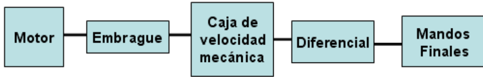
Fig. 4.4 Esquema del tren de fuerza de transmisión mecánica (F. Cáceres)
